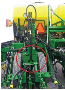
NOW THAT THE 1790 BRACKET IS INSTALLED, YOU CAN NOW MOUNT THE AGXCEL GX2 OR GX5 SYSTEM ON TOP OF THE 1790 BRACKET.
